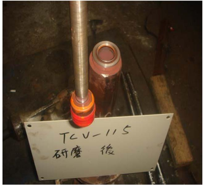
控制閥零件拆解後
